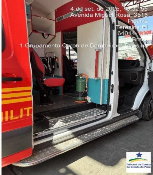
Figura 50 - Ambulância tipo C: Equipada com materiais de salvamento, além dos equipamentos médicos
